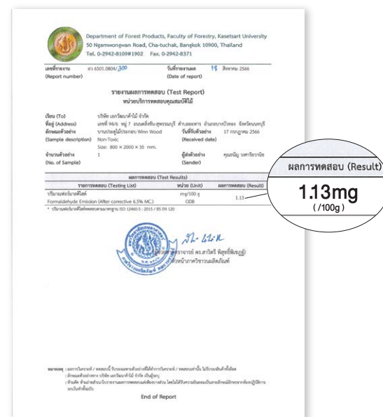
ผลการทดสอบสารฟอร์มัลดีไฮด์ ด้วยมาตรฐานยุโรป (EN120) บานประตู Non-Toxic จาก ม.เกษตรศาสตร์
